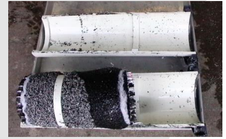
Exemple d'un PETRO PIPE saturé en hydrocarbures, coupé en deux montrant la matière active ayant formé un bouchon
